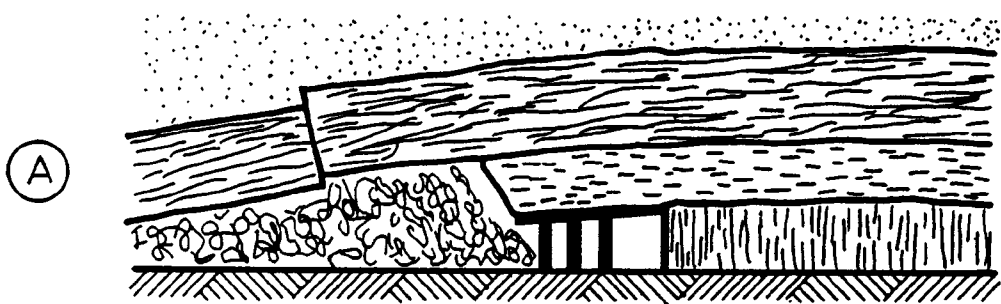
FIG. N o 4 — PROCESO DE HUNDIMIENTO DE UN TAJO LARGO
